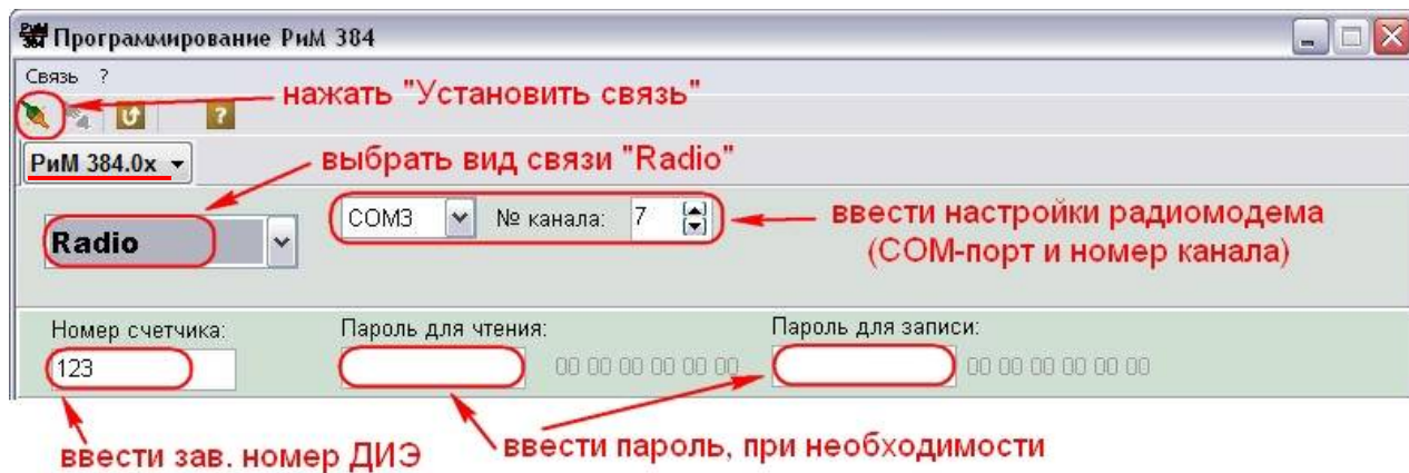
Рисунок В.7 – Порядок установки связи с ДИЭ с помощью конвертора USB-RF РиМ 043.02
