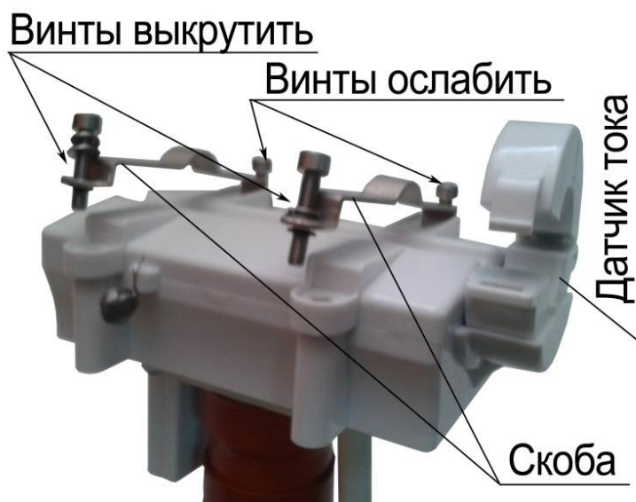
Рисунок 18 – Подготовка ДИЭ для установки на провод ВЛ
