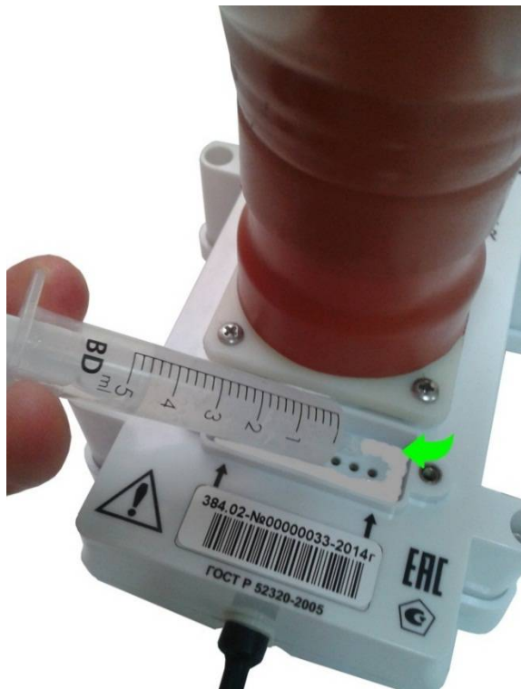
Рисунок 15 – Нанесение смазки силиконовой в гнездо для GSM-модема
